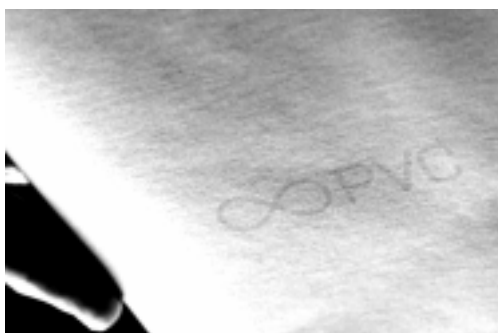
日本ビニル工業会の建装部会で定めたリサイクルのための「PVCマーク」
