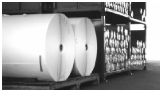
手前は印刷等の加工をする前の壁紙のベース。1ロールで2.5kmの長さ。奥は出荷をまつ製品。通常は1梱包が50m。
